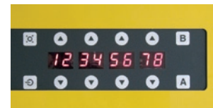
液晶パネルは大きなスイッチと標示番号の読み出しにより標示変更が簡単にでき、バッテリー残量やソーラーの状態を常時確認できます。
