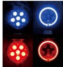
中心の超高輝度(φ5)LED6個外側の円形導光帯LED2個の計8個のLEDで点滅
