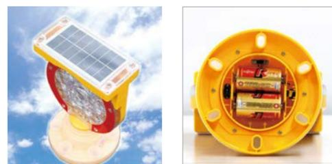
ソーラー充電(ニッケル水素電池)と単1アルカリ乾電池のハイブリッド切り替え式。ソーラー充電の残量がなくなると乾電池に自動で切り替わります。
